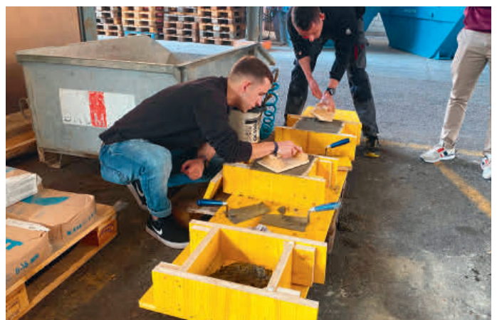
Betonieren des Würfels
