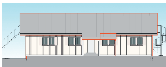
Neue Fassadenpläne mit hinterlüfteter Holzfassade
